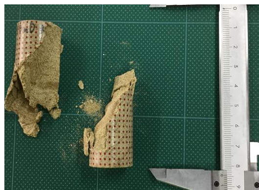
破壊後のベレア砂岩供試体 (150mD, 葉理面角度 45 度)
